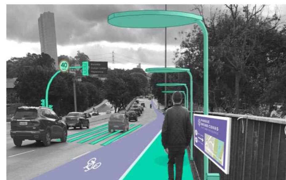
Proposta de Melhoria na Ponte João Dias, incluindo a faixa de pedestres para travessia ao local onde é possível entrar no Parque. Fonte: Caminhando juntas, engajando mulheres na construção de cidades caminháveis que enfrentam a crise climática. Instituto Caminhabilidade.
