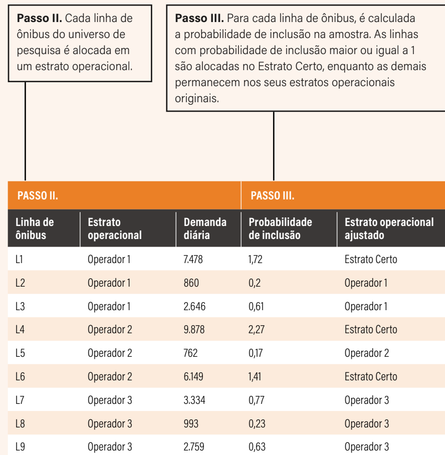
Figura EP 1.2 | Definição dos estratos operacionais e cálculo da probabilidade de inclusão na amostra
